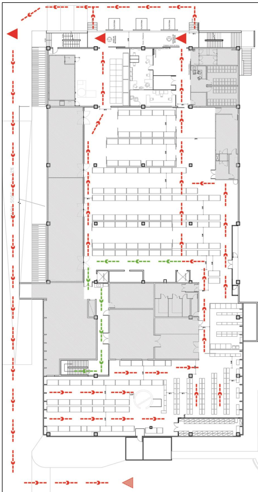
Figura 26: Layout e rotas de fuga - existente, São Paulo – SP
